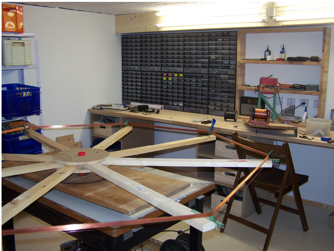
Bild 9.5: Neue Spulenwickelmaschine für 1,8m-Spule (2011)
