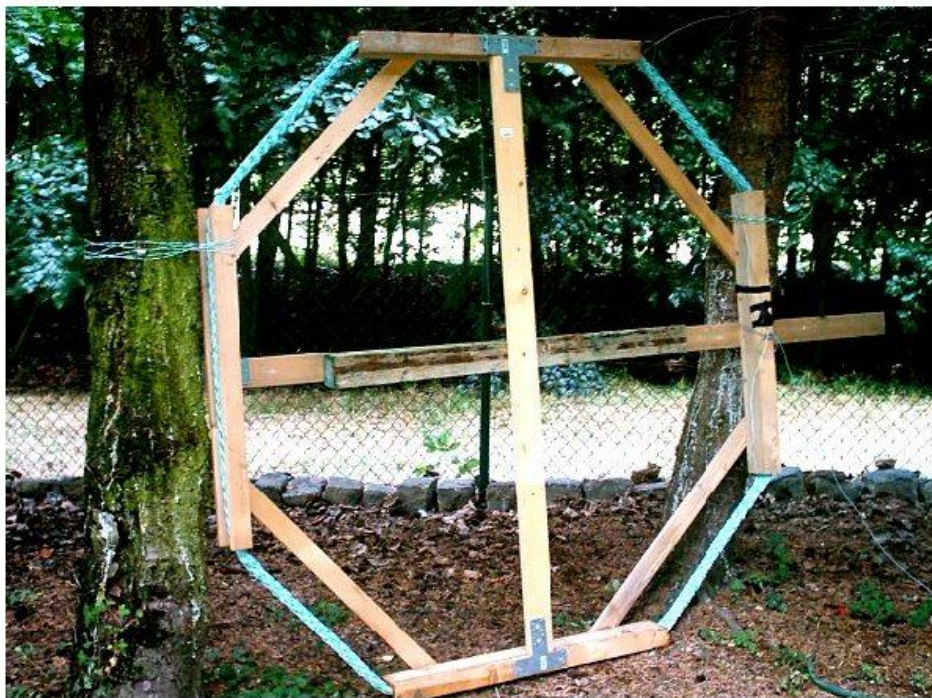
Bild 9.2: Versuchsantenne mit 1,7 m Durchmesser
